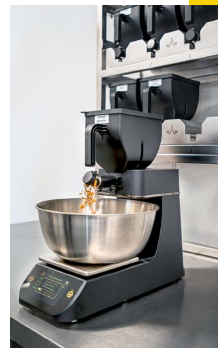
Autogram herkent het juiste ingrediënt en weegt dat af tot op 0,2 gram nauwkeurig.
